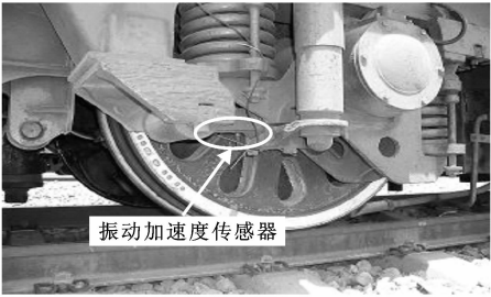
图 3 机车振动测试中传感器的安装位置
